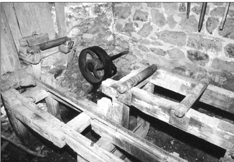
Moulin de Villevaleix : quand le banc de scie était actionné par les roues à cuillers (détail de la transmission)
