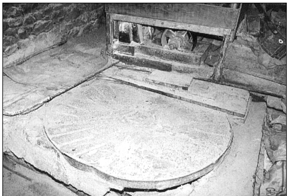
Moulin de Villevalaix : dans la salle des meules, la meule dormante encore en place au pied du broyeur en activité
