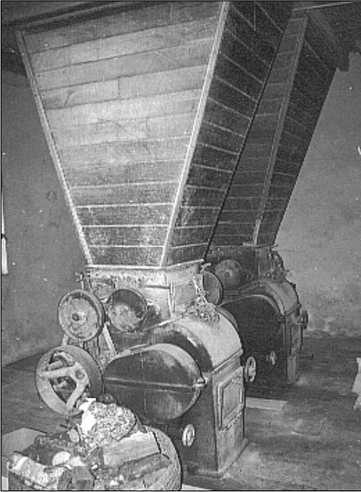
Moulin de Vaux : les appareils à cylindres encore en place
