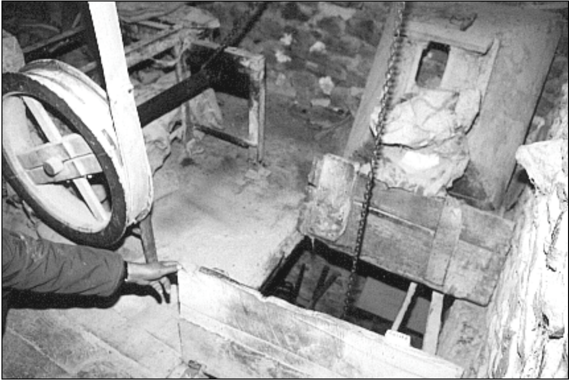
Moulin de Villevalaix : le monte-sacs, la trappe en position ouverte et la chaîne
