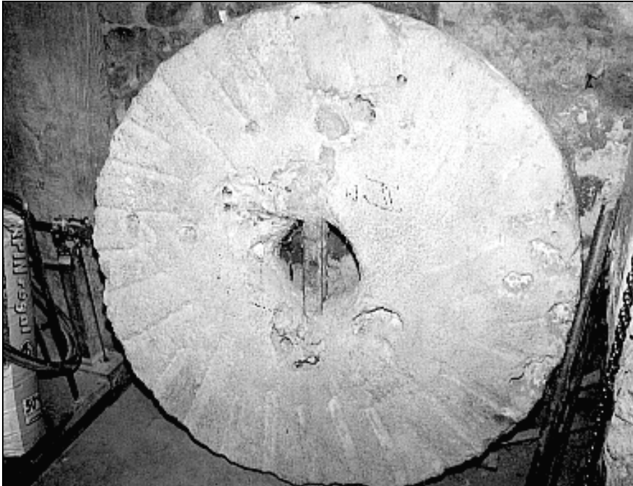
Moulin de Villevaleix : gros plan sur la meule tournante
