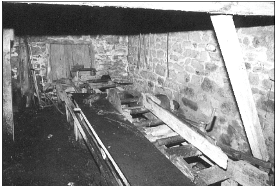
Moulin de Villevaleix : le banc de scie, vue d'ensemble
